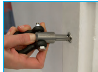
... Steckbolzen in Hülse führen ...
